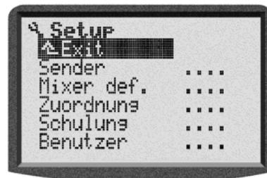
Die erste Zeile zeigt das Hauptmenü an, in dem Sie sich gerade befinden (Bsp. Hauptmenü Setup: „
