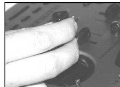
Die obere Taste  $KT_a$  hat eine Tastfunktion. Die beiden seitlichen Tasten bilden zusammen den Schalter  $KS_w$ . Dieser Knüppelgriff wird mit zwei Drähten an die Senderelektronik angeschlossen. Die Taste und die Schaltfunktion können Gebern und Schaltern auf die gleiche Art zugeordnet werden, wie die anderen Tasten (H und M) und Schalter.
