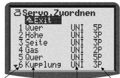
Spalte 1 Servo-Nr. Spalte 2 Geber od. Mischer Spalte 3 Impulsformat Spalte 4 Anzahl Abgleichpunkte
