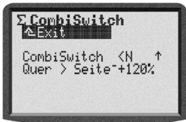
Der Schalter für den Combi-Switch wird im Menü **ZUORDNUNG, SCHALTER** ausgewählt und hier nur als Information angezeigt. Der Pfeil dahinter zeigt an, ob die Schalterstellung für Combi-Switch EIN hinten oder vorne ist.
