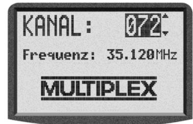
Anschließend wird die zuletzt verwendete Statusanzeige angezeigt. Falls alles in Ordnung ist, wird das Synthesizer-HF-Modul aktiviert und das HF-Signal (Hochfrequenz-Signal) wird sofort abgestrahlt. Die LED beginnt zu blinken, das Display wechselt zur zuletzt aktiven Statusanzeige, der Sender ist betriebsbereit.
